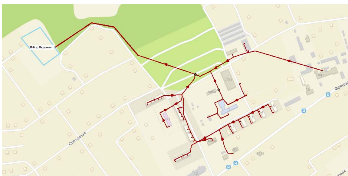
Рисунок 3.30 - Существующая схема коллекторов системы водоотведения д. Огуднево
