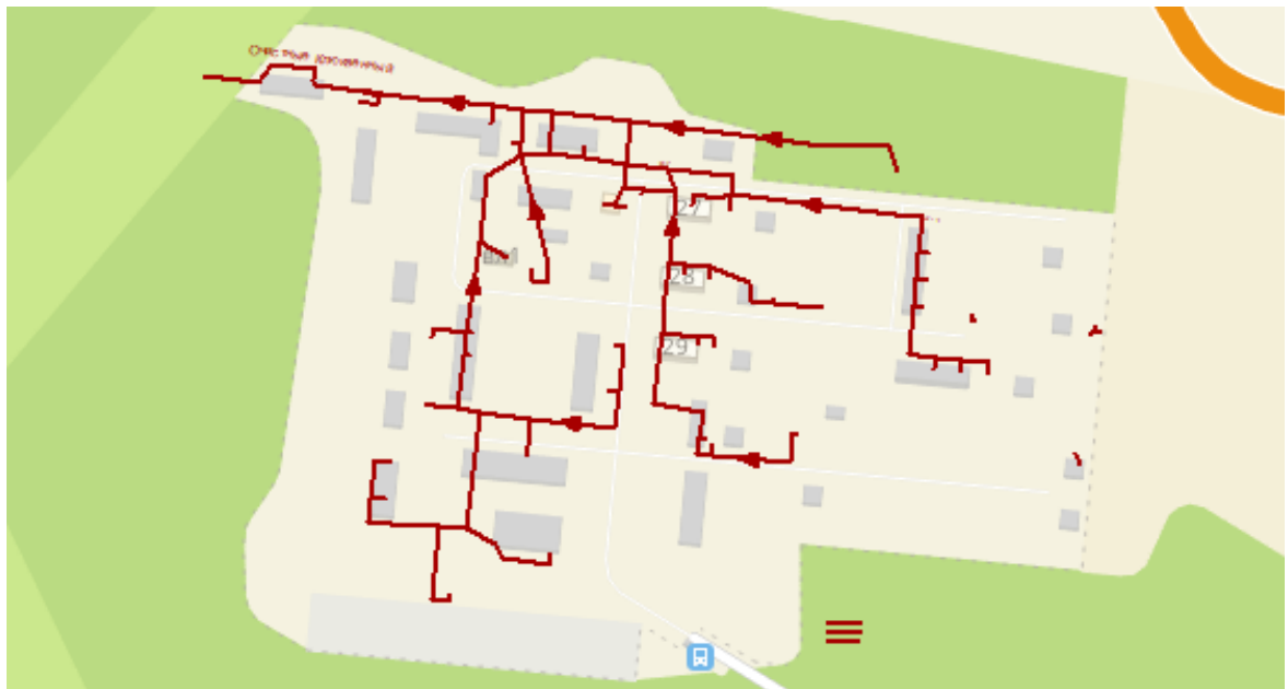
Рисунок 3.56 - Существующая схема коллекторов системы водоотведения п. Клюквенный
