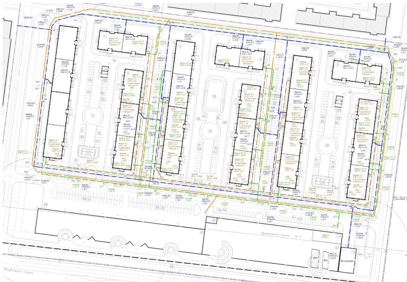
Рисунок 3.32 - Существующая схема коллекторов системы водоотведения ЖК «Восточная Европа» в д. Большие Жеребцы (оранжевые линии)
