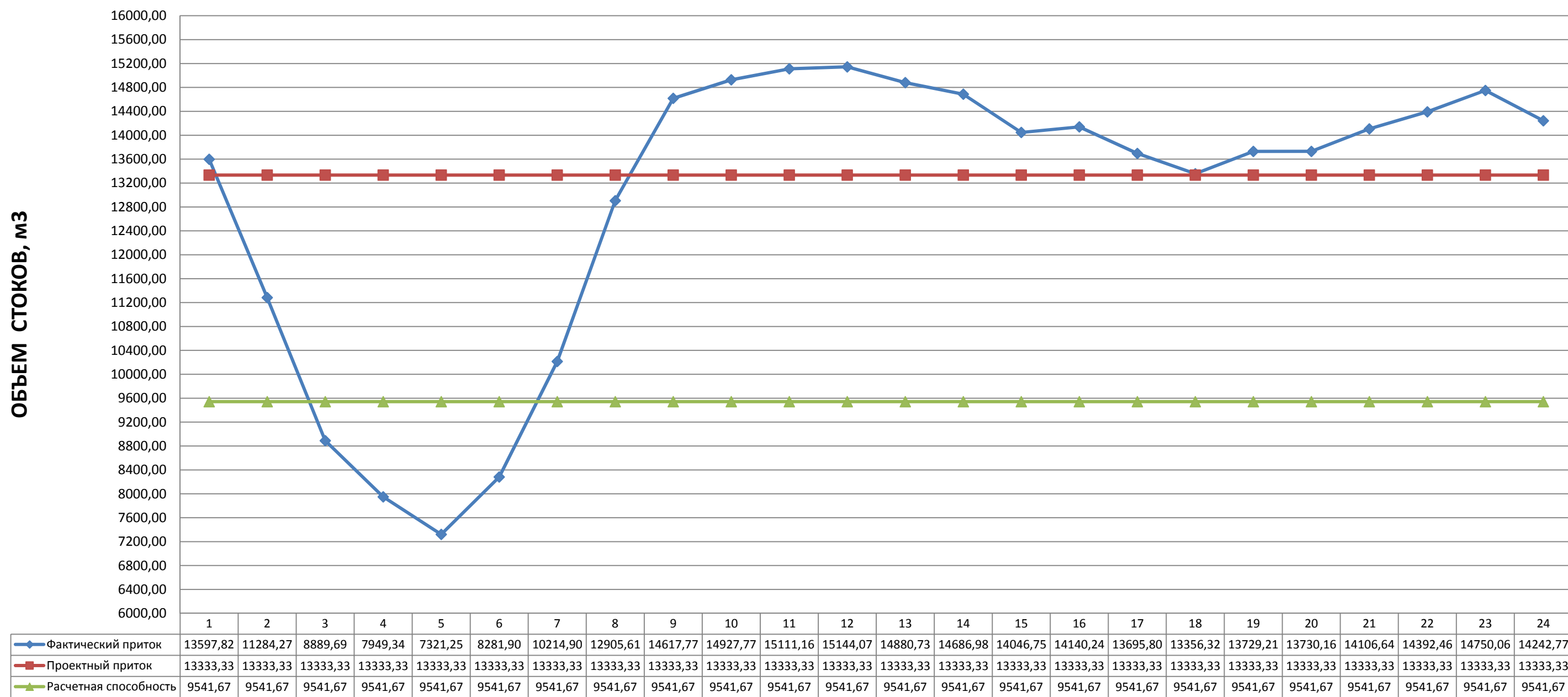
Рисунок 3.44 – График фактического поступления стоков на ЦМОС в течение характерных суток в марте 2020г.
