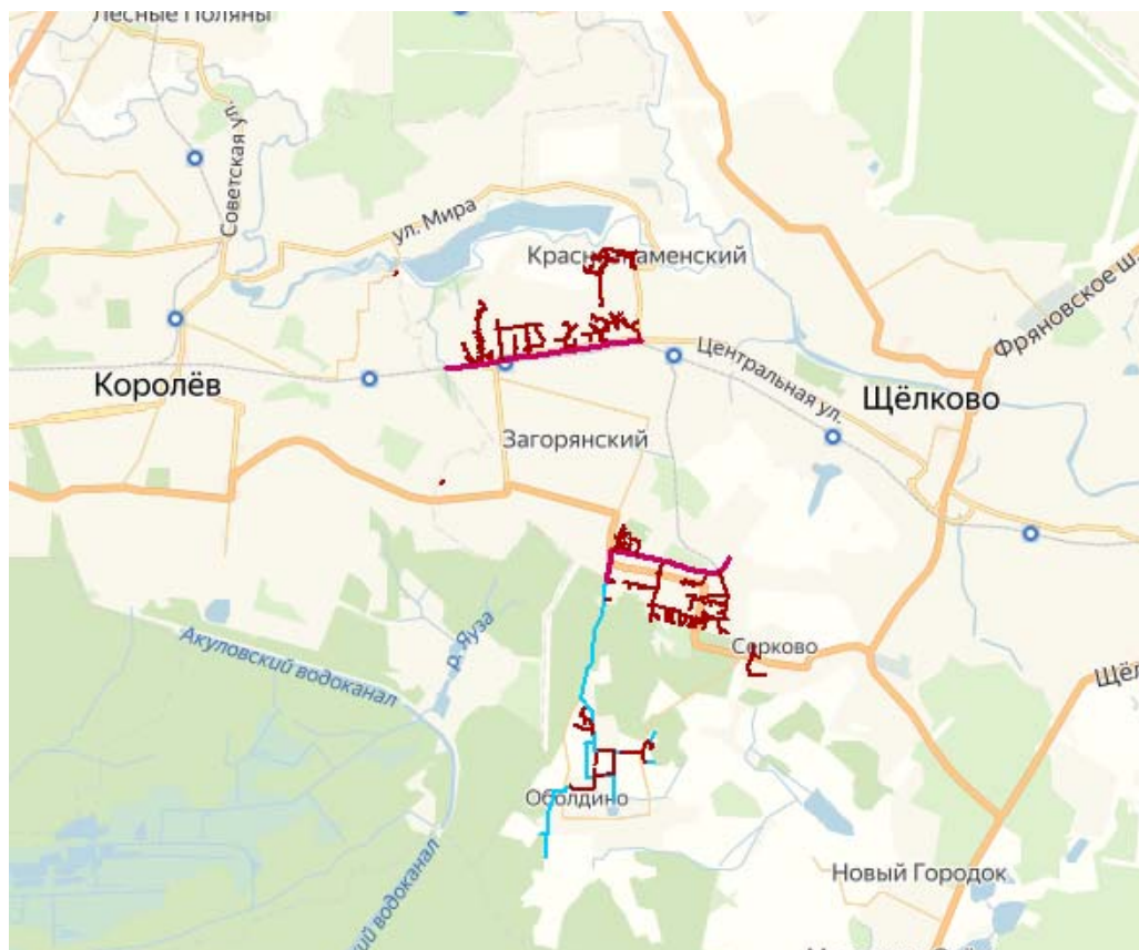
Рисунок 3.51 - Существующая схема коллекторов системы водоотведения г.п. Загорянский (бывш.)
