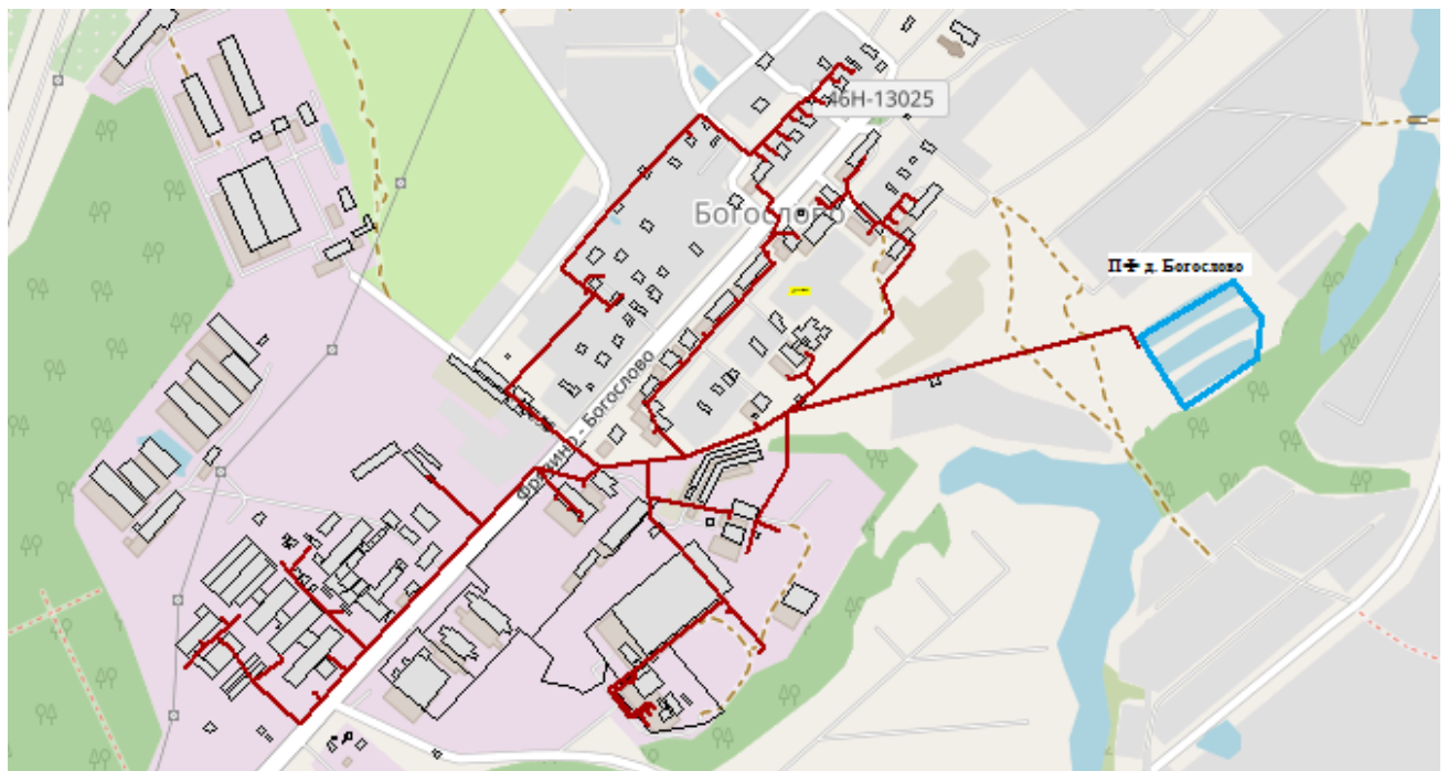
Рисунок 3.50 - Существующая схема коллекторов системы водоотведения д. Богослово
