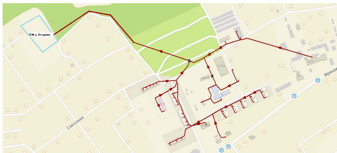
Рисунок 3.55 - Существующая схема коллекторов системы водоотведения д. Огуднево
