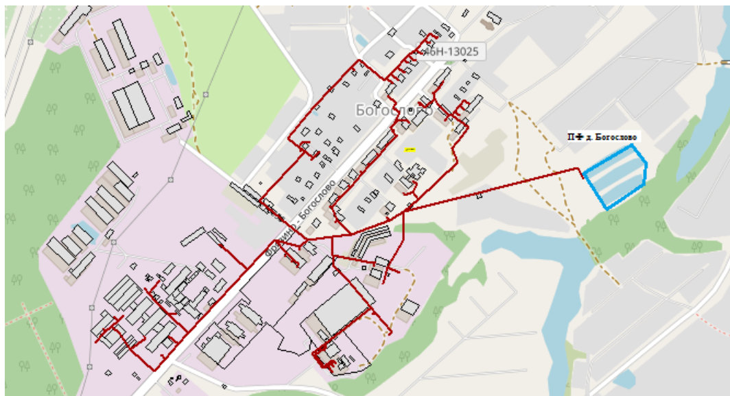
Рисунок 3.25 - Существующая схема коллекторов системы водоотведения д. Богослово
