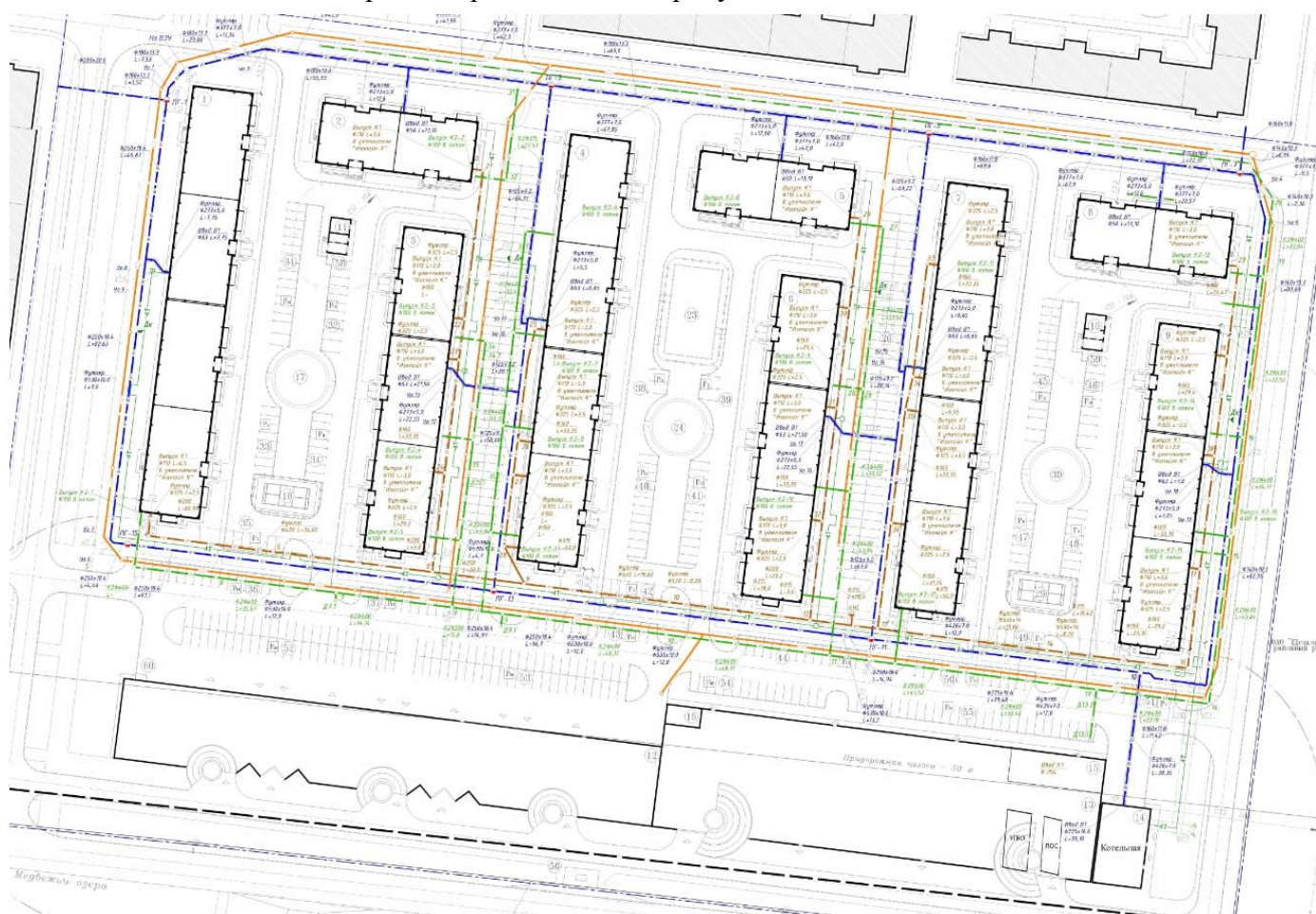
Рисунок 3.33 - Существующая схема коллекторов системы водоотведения в д. Большие Жеребцы (оранжевые линии)
