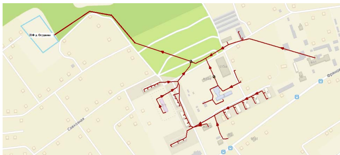
Рисунок 3.58 - Существующая схема коллекторов системы водоотведения д. Огуднево
