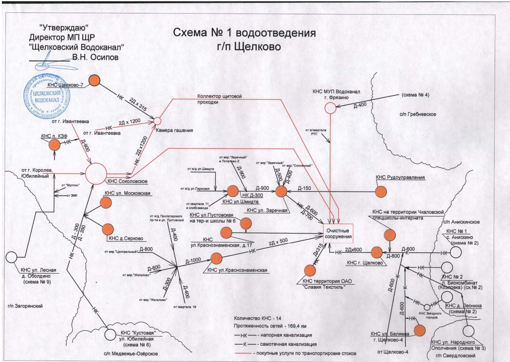
Рисунок 3.11 - Схема организации системы централизованного водоотведения г.о. Щелково
