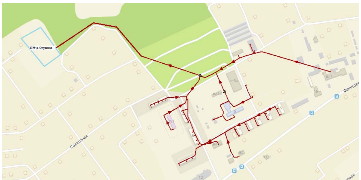
Рисунок 3.31 - Существующая схема коллекторов системы водоотведения д. Огуднево
