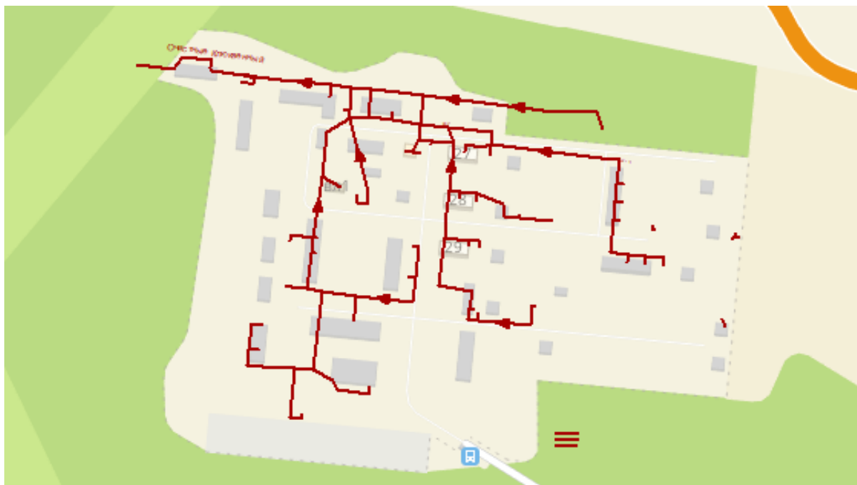
Рисунок 3.32 - Существующая схема коллекторов системы водоотведения п. Клюквенный
