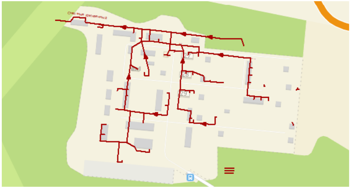
Рисунок 3.59 - Существующая схема коллекторов системы водоотведения п. Клюквенный
