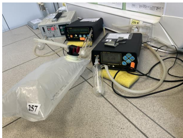
Фото 1 – газоанализаторы «Палладий-ЗМ-01» и «Элан плюс СО-50» для анализа проб атмосферного воздуха на содержание оксида углерода
