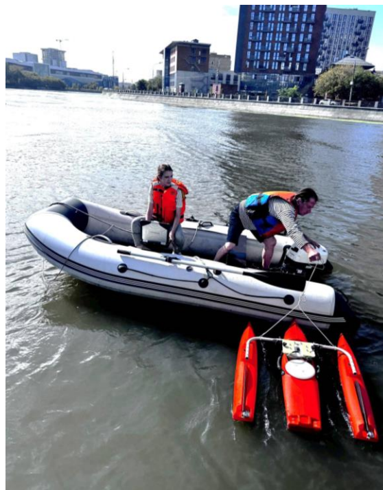
Фото 3 – Гидролог I категории Якименко А.С. и капитан-механик Назарьянц С.С. проводят обследование акватории реки Москва с помощью профилографа
