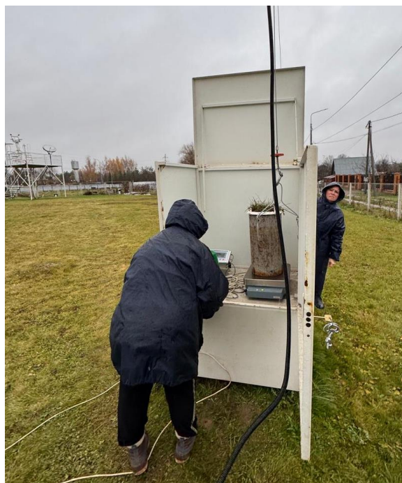
Фото 6 – Начальник В Подмосковная Плотникова В.А. взвешивает почвенный монолит для измерения влажности почвы.
