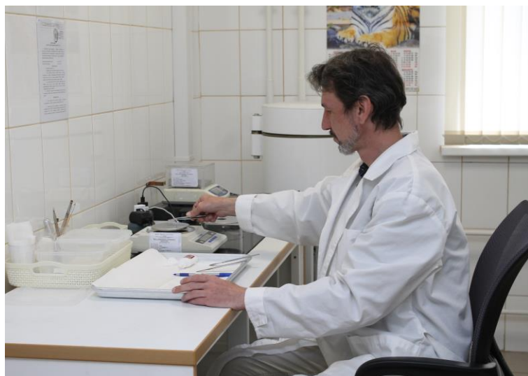
Фото 4 – Радиометрист I категории ОРМ ЦМС Киреев А.С. проводит пробоподготовку счетного образца для дальнейшего определения суммарной бета-активности радионуклидов
