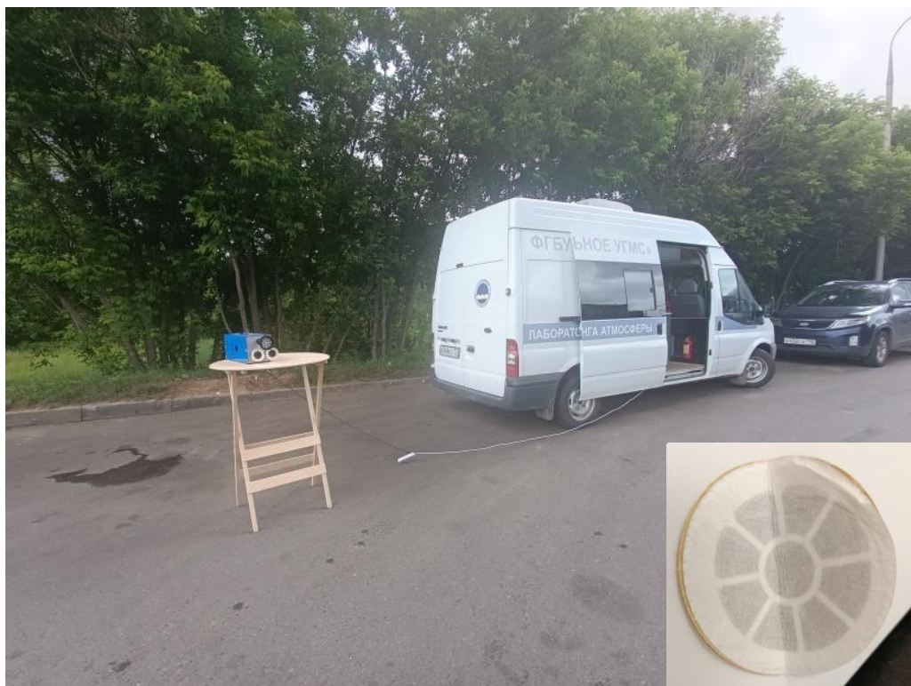
Фото 1 – Отбор проб атмосферного воздуха на взвешенные вещества, мобильная экологическая лаборатория
