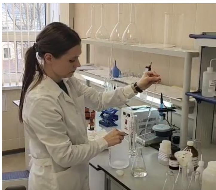
Фото 2 – Смирнова Е.А., ведущий гидрохимик ОМПВ ЦМС, определение общей жесткости воды
