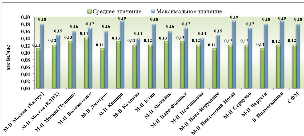
Рисунок 32- Среднегодовые и максимальные значения мощности AMBIENTНОГО эквивалента дозы гамма-излучения (МАЭД ГИ) на станциях Московского региона по данным наблюдений ФГБУ «Центральное УГМС» за 2024 год
