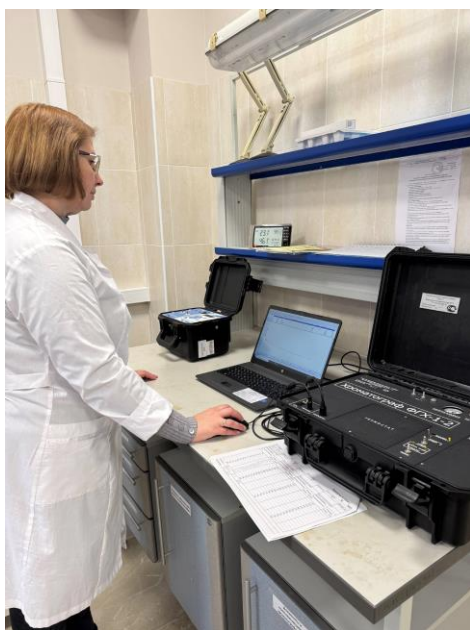
Фото 1 – определение предельных углеводородов на газовом хроматографе Хроматэк «Кристалл 5000».
