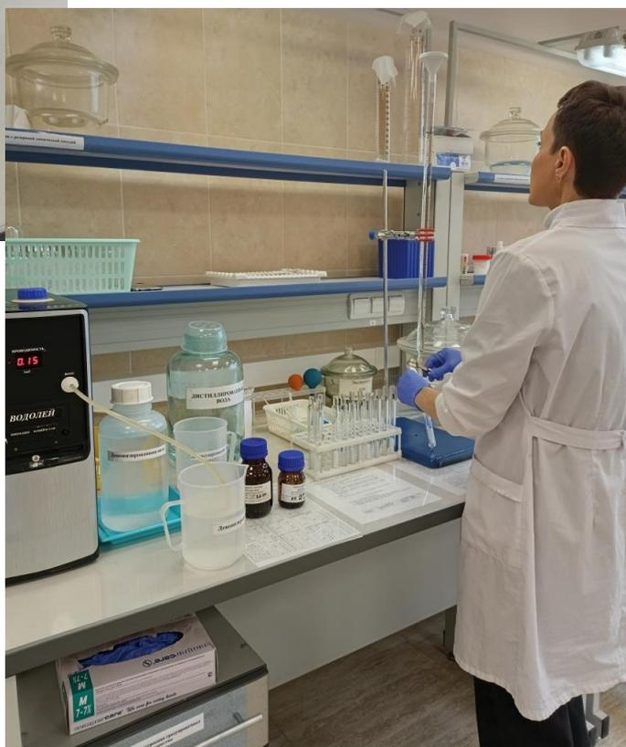
Фото 1 и 2 – Афанасенкова О.А. аэрохимик II кат. ЦЛНЗ ОМА, подготовка сорбционных трубок к выполнению измерений проб атмосферного воздуха на аммиак фотометрическим методом
