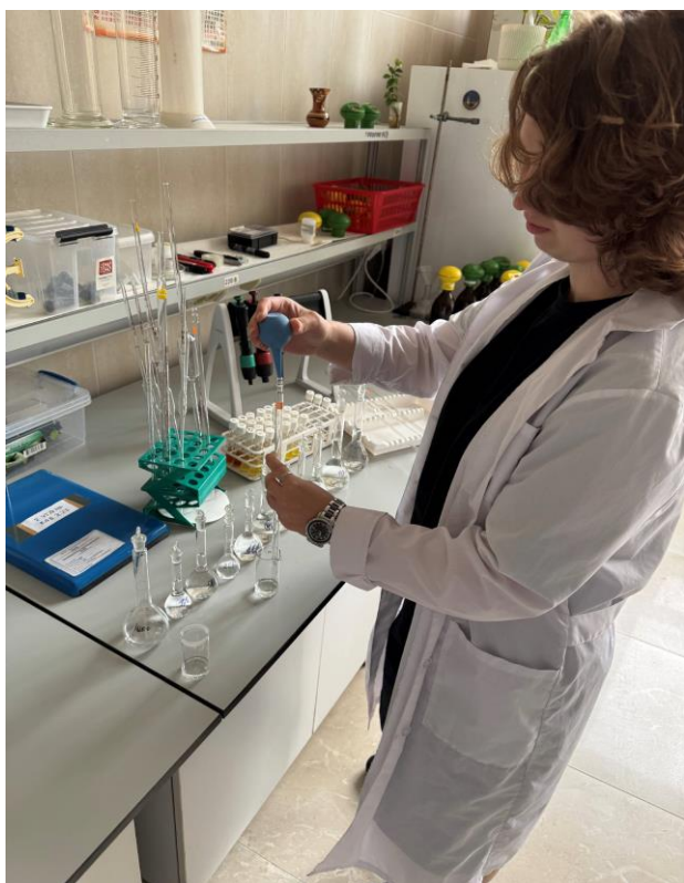
Фото 4 – Кутенкова М.В., гидрохимик I категории ОМПВ ЦМС, градуировка Анализатора Флюорат 02-5М для определения бихроматной окисляемости в пробах воды
