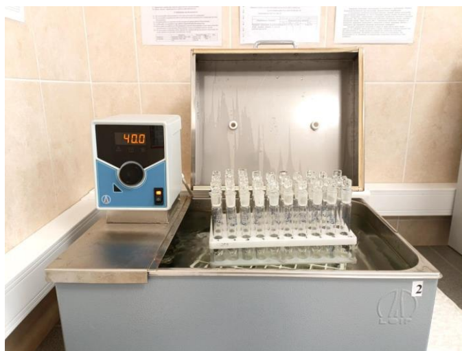
Фото 1, 2 – Термостатирование проб для определения массовой концентрации формальдегида в атмосферном воздухе
