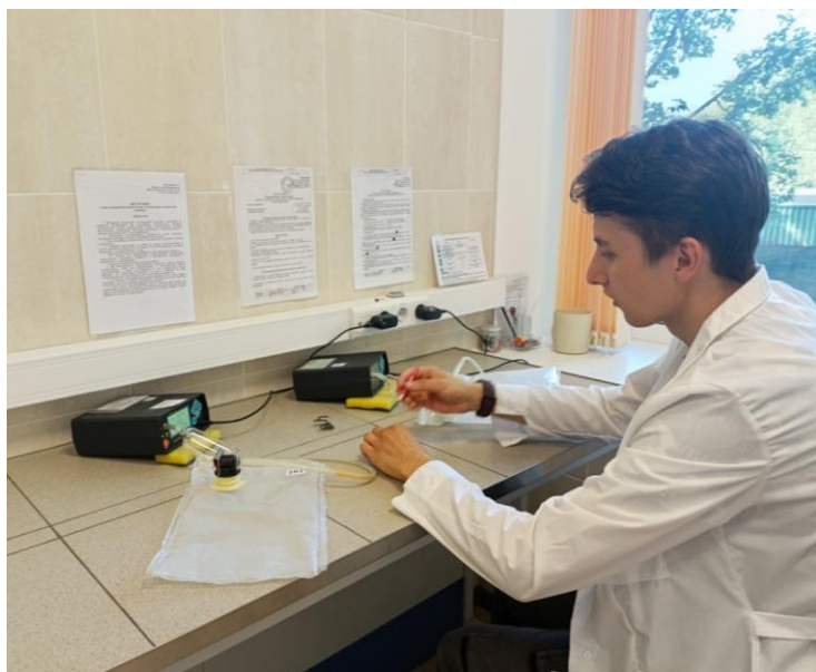
Фото 3 – Определение массовой концентрации оксида углерода в атмосферном воздухе. Исполнитель Веришин М. А., студент - практикант РГГУ имени Серго Орджоникидзе
