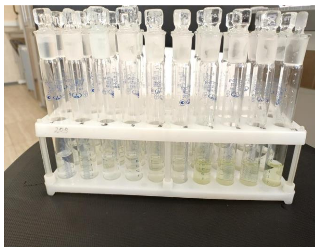
Фото 1, 2 – Термостатирование проб для определения массовой концентрации формальдегида в атмосферном воздухе
