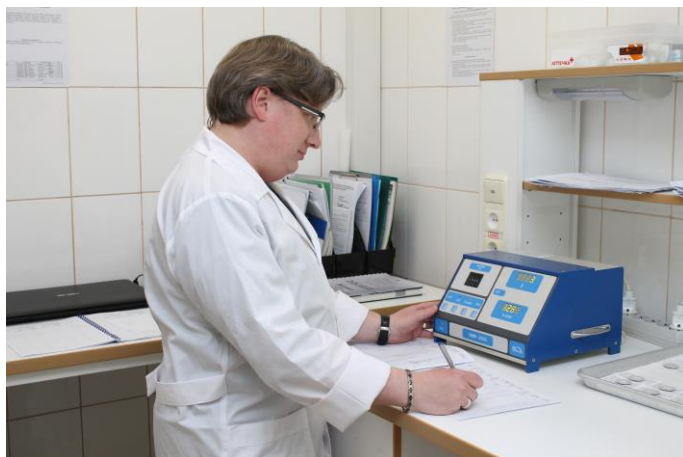
Фото 3 – Начальник ОРМ ЦМС Крюков Д.С. проводит измерения суммарной бета-активности проб радиоактивных выпадений с помощью Альфа-бета радиометра «УМФ-2000»
