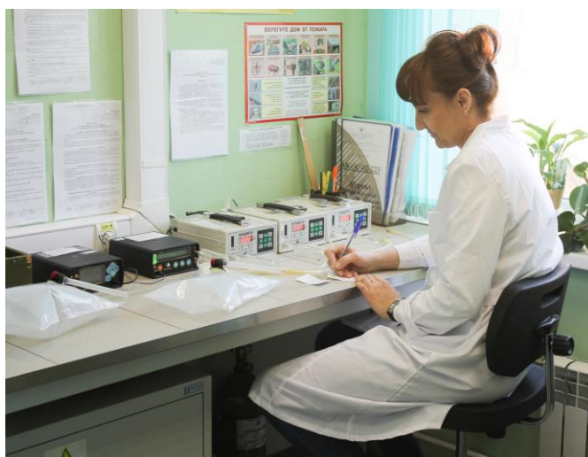
Фото 1: Афанасенкова О.А., аэрохимик II кат., измерение массовой концентрации оксида углерода на газоанализаторах Элан плюс и Палладий 3М-01
