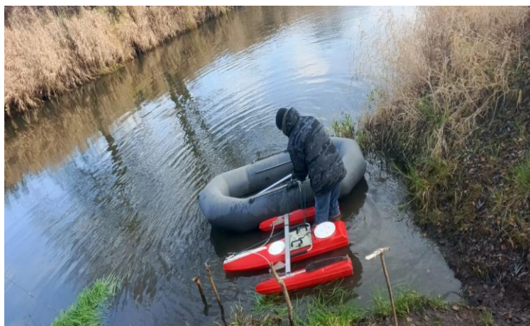
Фото 5 – р. Жиздра - ГП Дубровка, измерение расходов воды, ноябрь
