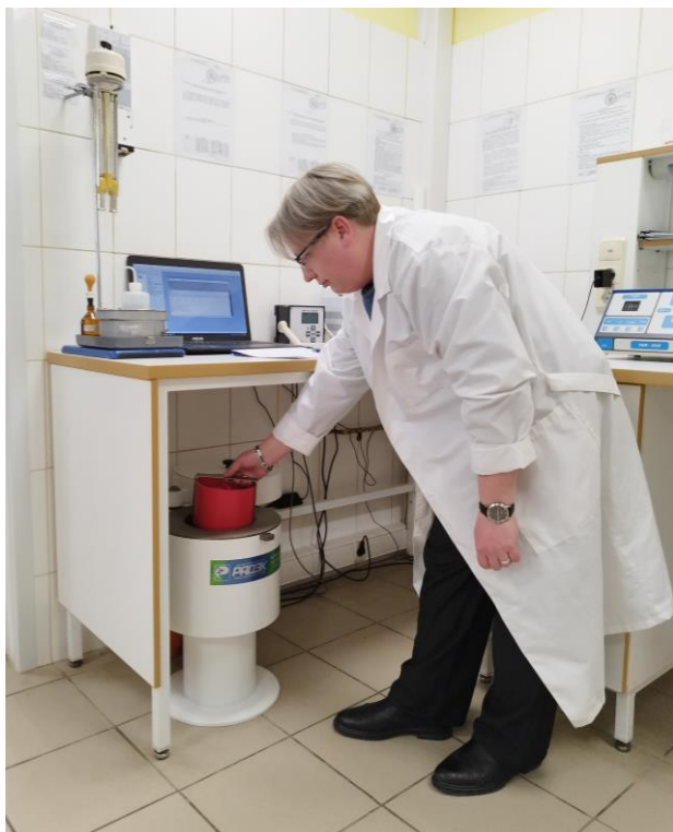
Фото 1: Начальник ОРМ ЦМС Крюков Д. С. проводит измерение удельной активности радионуклидов в пробах почвы спектрометрическим методом на гамма-спектрометре МКСП-01 "РАДЭК".
