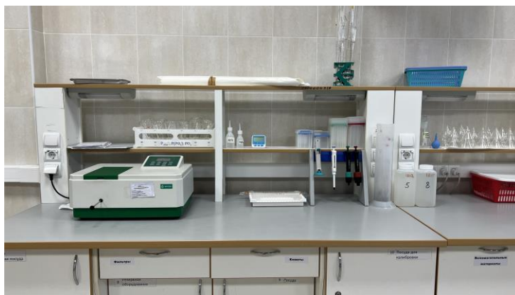
Фото 2 – Рабочий стол для определения фосфора и фосфатов фотометрическим методом анализа в поверхностных водах.
