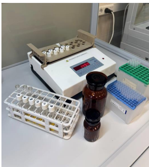
Фото 3 – Определение бихроматной окисляемости (химического потребления кислорода) в пробах поверхностных вод фотометрическим методом анализа с применением анализатора жидкости "Флюорат-02"
