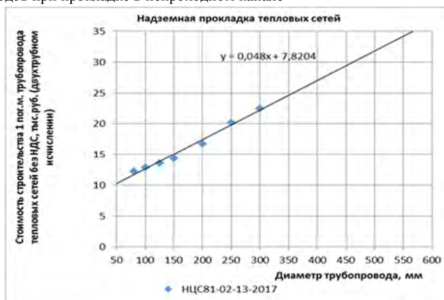
Рисунок 34 – Зависимость стоимости строительства трубопроводов тепловых сетей от диаметра трубопроводов при надземной прокладке на низких опорах
