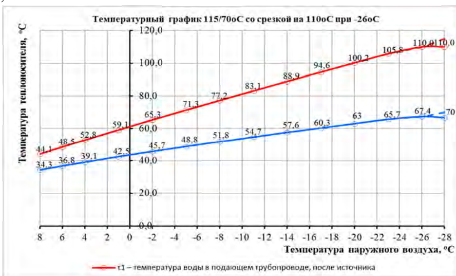
Рисунок 29 – Температурный график 115/70°C со срезкой на 110°C при -26°C котельной №2 п. Монино, ул. Баранова, д.12 ООО "ТеплоВодоСнабжение"
