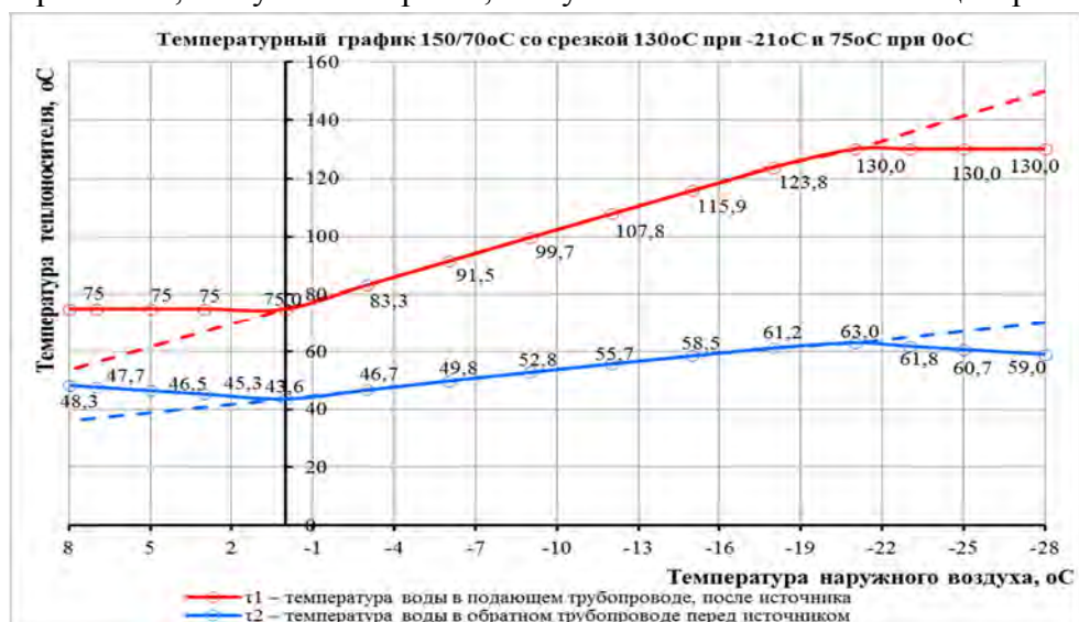
Рисунок 27 – Температурный график 150/70°C со срезкой 130°C при -21°C и 75°C при 0°C котельной, ул. Фабричная, д.1 ООО «Теплоцентральный»
