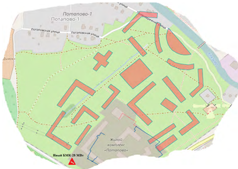
Рисунок 13 – Зона действия новой котельной БМК-28 МВт
