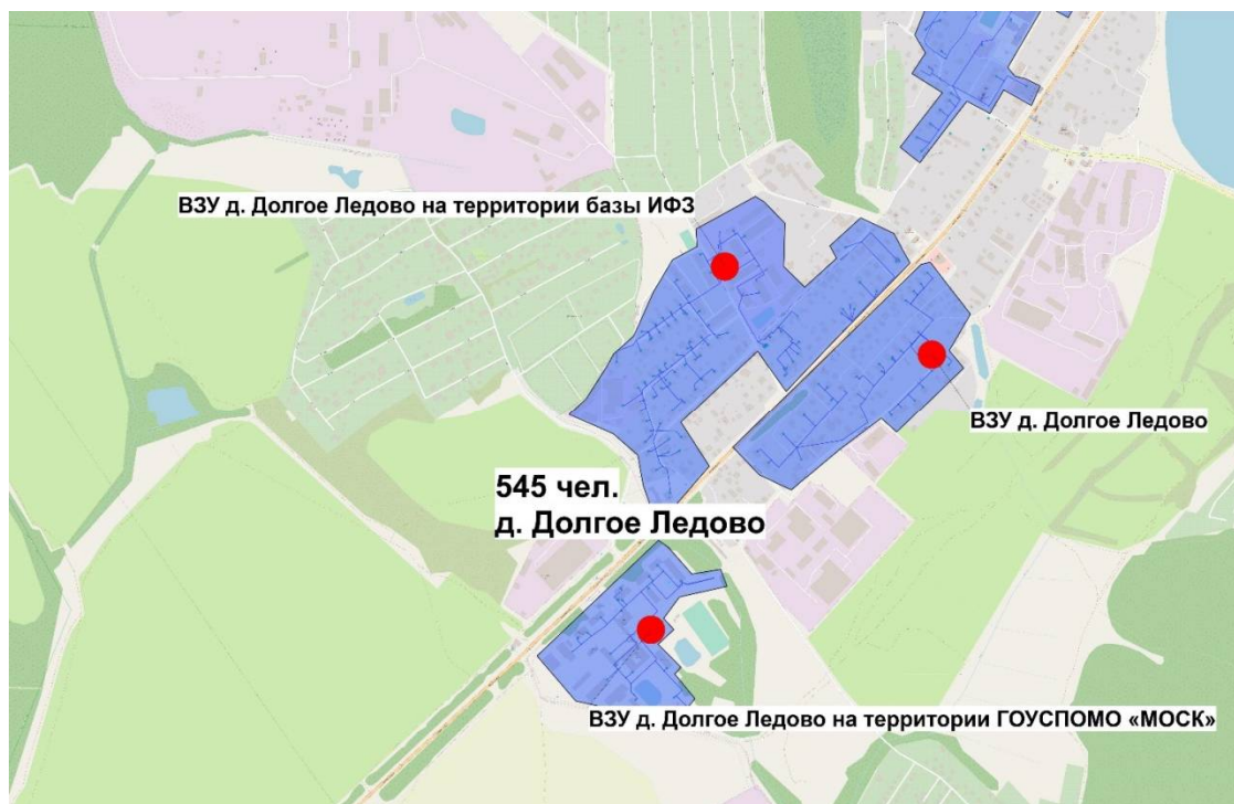
Рисунок 2.5 – Ситуационная схема зон действия ВЗУ: ВЗУ д. Долгое Ледово на территории базы ИФЗ, ВЗУ д. Долгое Ледово, ВЗУ д. Долгое Ледово на территории ГОУСПОМО «МОСК»
