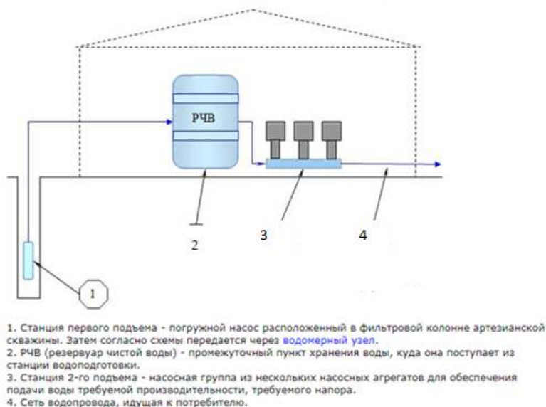
Рисунок 2.47 – Принципиальная технологическая схема ВЗУ не полного цикла
