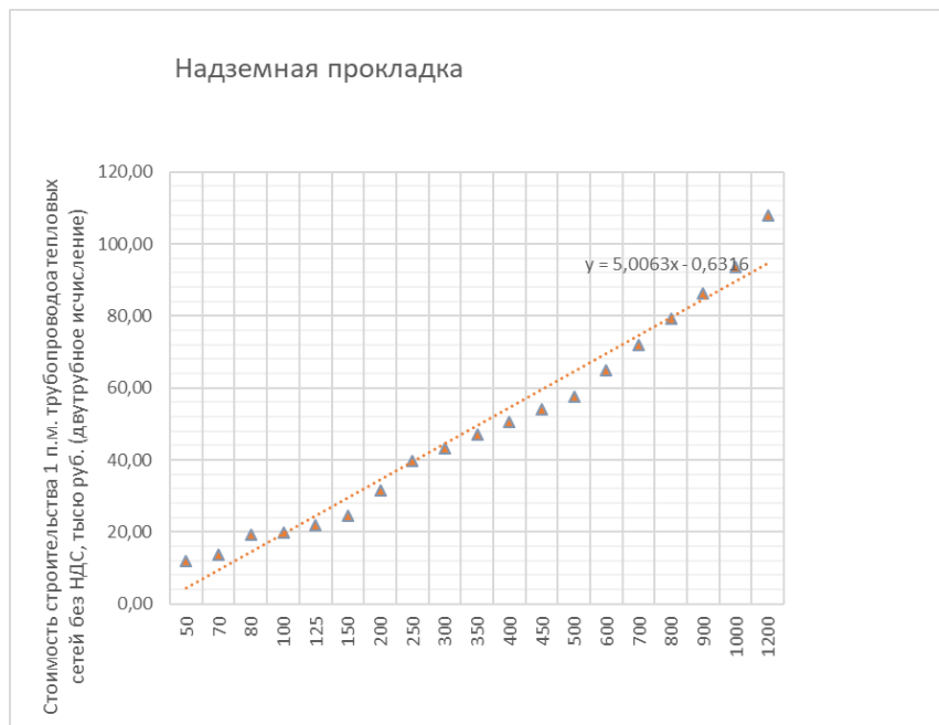
Рисунок 18 – Зависимость стоимости строительства трубопроводов тепловых сетей от диаметра трубопроводов при надземной прокладке на низких опорах
