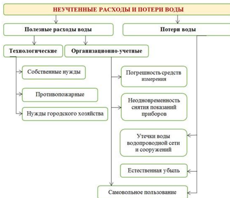
Рисунок 3.1 - Структура неучтенных расходов и потерь воды
